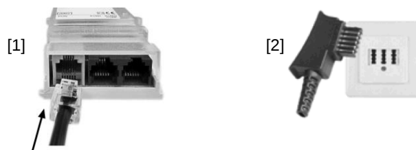
Abbildung 42: Anschluss an das Telefonnetz
